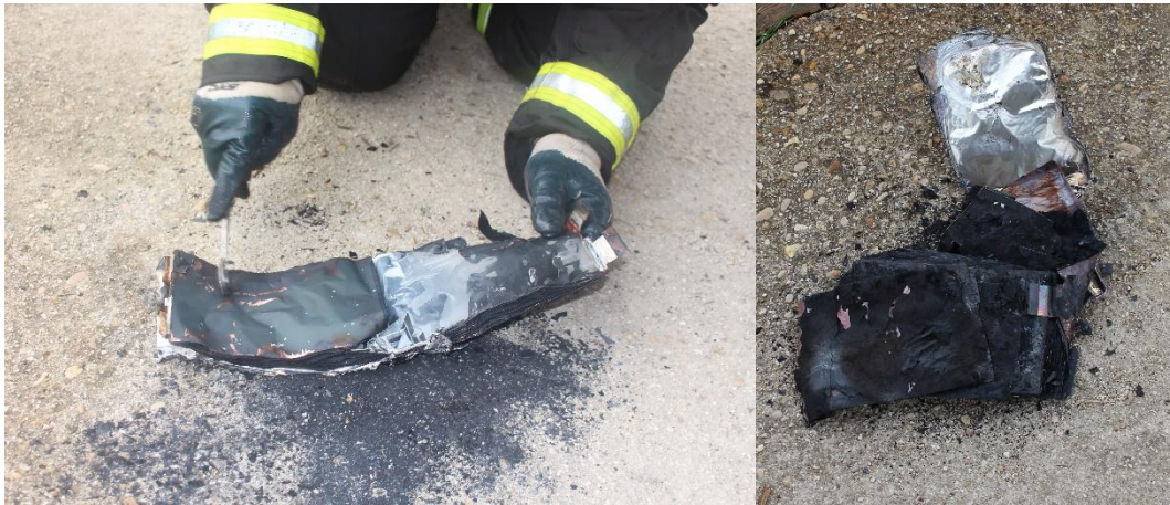
Figura 6 Residui di celle EIG-C020 dopo prove di esposizione a fiamma.
