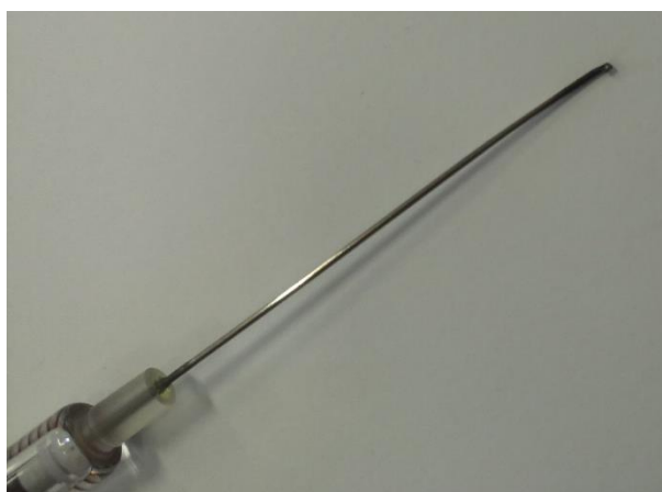
Figura 19 Ago della siringa da gas usata per il campionamento.
