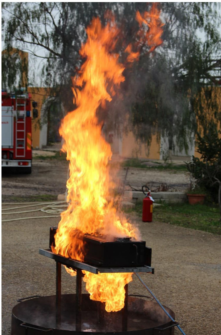
Figura 5 Prova di esposizione a fiamma di un case di 48 celle EiG-C020.
