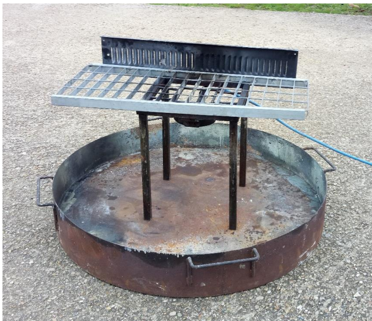
Figura 1 Braciere a GPL per le prove di esposizione a fiamma.
