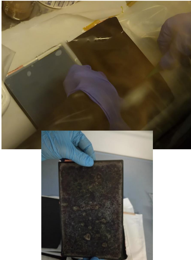
Figura 25 Anodo di una cella EiG-C020 vergine (sinistra) e rigonfia (destra).
