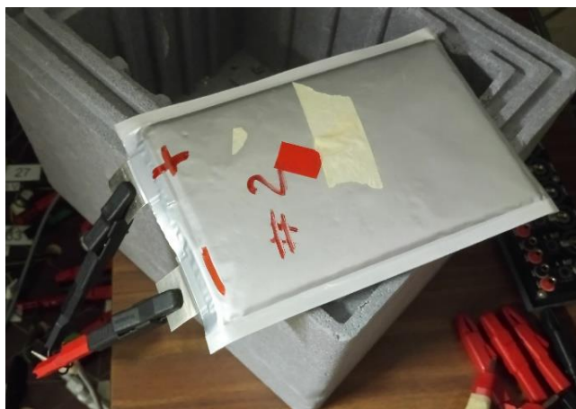
Figura 16 Dispositivo di scarica della cella EiG-C020 rigonfia.
