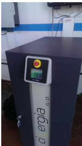
Figura 10. Il Carico elettronico rigenerativo da 15 kVA utilizzato nelle prove.
