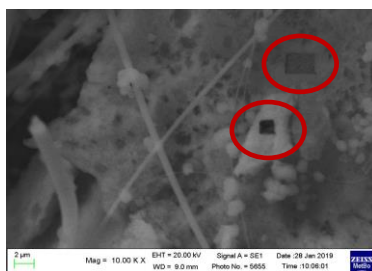
Figura 13. Immagine SEM dell'elettrodo C3h/poAP post-mortem in cui sono evidenziate in rosso le due zone su cui è stata effettuata l'analisi EDS.
