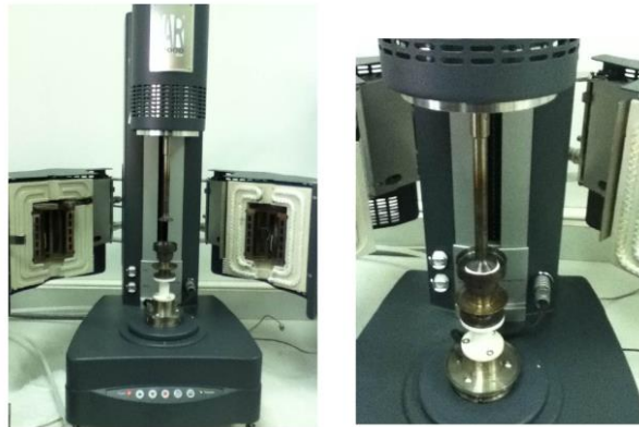
Figura 3. Reometro utilizzato per le prove di viscosità dinamica. A destra: particolare della geometria a piani paralleli con statore (sotto) e del rotore (sopra) con, fra i due elementi, il campione
