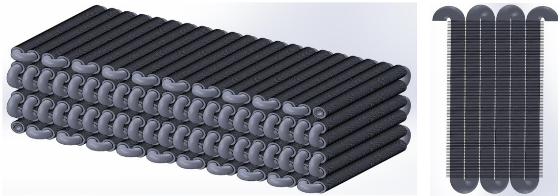
Fig.24 – Fascio tubiero dello scambiatore di calore con miscela di sali ternari e unità ripetitiva del
