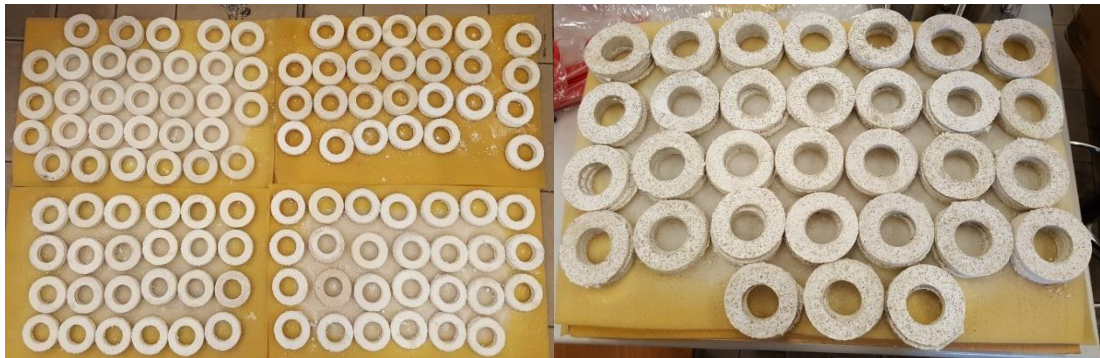
Figura 17. Schiume ceramiche (a sinistra) e materassino termoespandente (a destra) sagomati e forati per essere alloggiati all'interno del dispositivo filtrante
