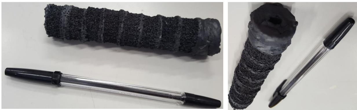
Figura 5. Filtro catalitico realizzato con la schiuma ceramica in SiC e allumina da 65 ppi
