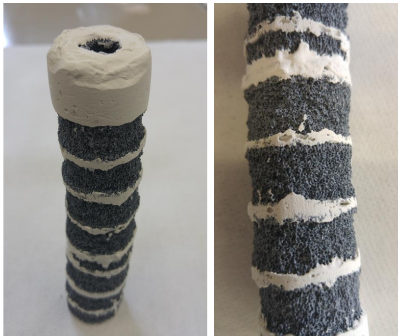
Figura 16. Filtro a schiume ceramiche a media porosità nuovo. Vista con il foro di uscita dei fumi (a sinistra) e ingrandimento delle pareti porose (a destra)
