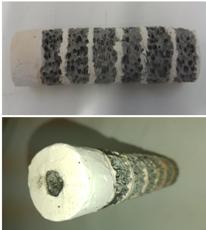
Figura 14. Filtro a schiume ceramiche ad alta porosità. Sezione laterale (in alto) e in prospettiva con il foro di uscita dei fumi (in basso)
