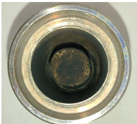
Figura 22. Vista dall'alto del secondo filtro a schiume ceramiche a media porosità nel suo alloggiamento al termine delle prove sperimentali
