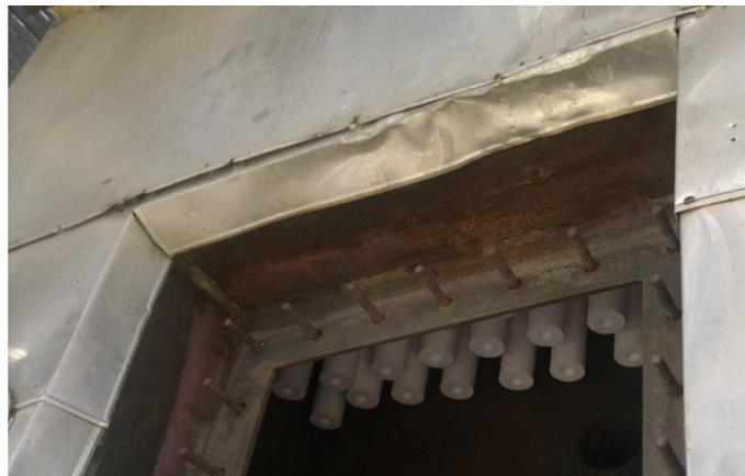
**Figura 3. Dettaglio sul sistema a candele ceramiche per alta temperatura per filtrazione del gas prodotto, integrato nel *freeboard* del reattore di gassificazione ICBFB 1000 kW<sub>t</sub>**
