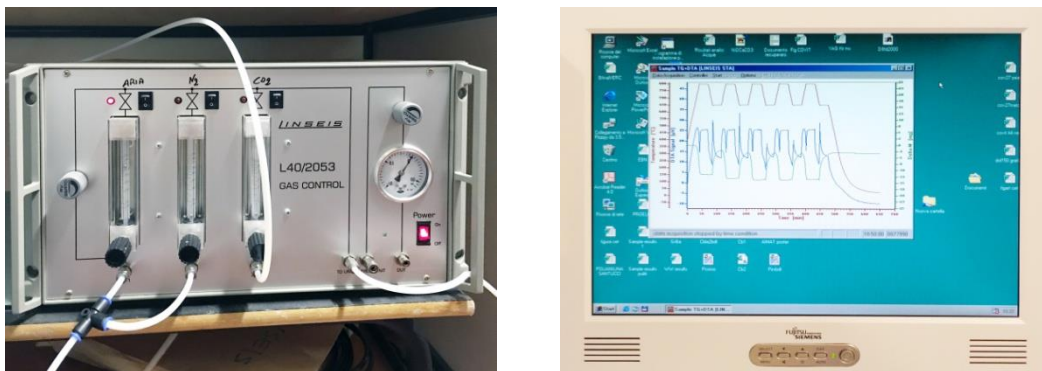
Figura 25. Flussimetri e software collegati alla TG - DTA Linseis L81
