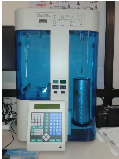
Figura 17. Porosimetro ad azoto mod. Nova 1200e Alfatest
