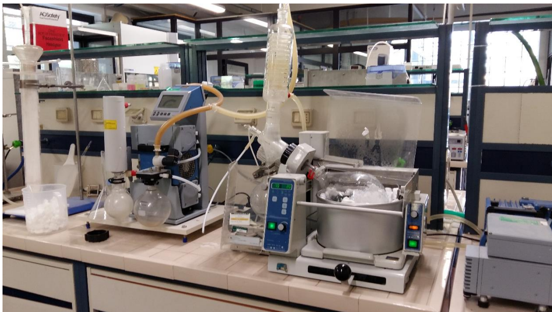
Figura 11. Wet impregnation in rotavapor
