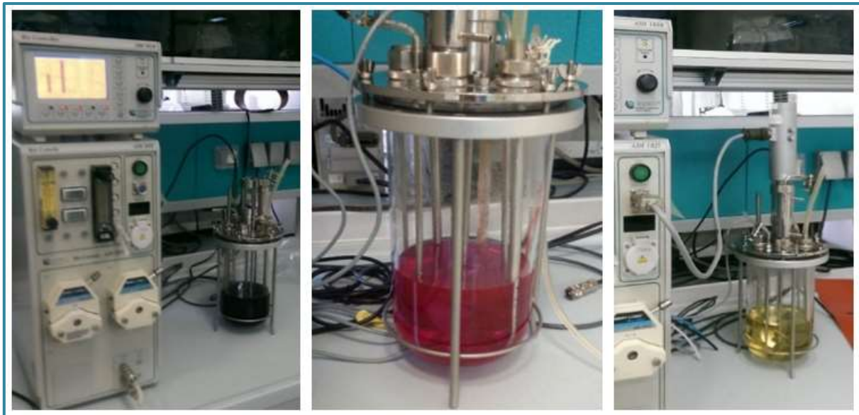
Fig. 5. Fasi dell'ottenimento delle condizioni di anaerobiosi in bioreattore, tramite flussaggio con CO 2 , del terreno modificato (con Na 2 CO 3 2,4 g/L)
