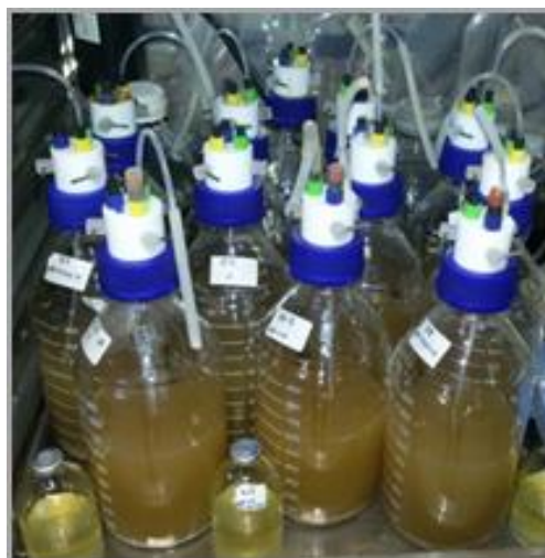
Figura 11. Allestimento della II Serie Sperimentale usando reattori da 1,2 L con tappo a tre vie: i reattori sono stati posti nel termostato, a 37 °C e al buio
