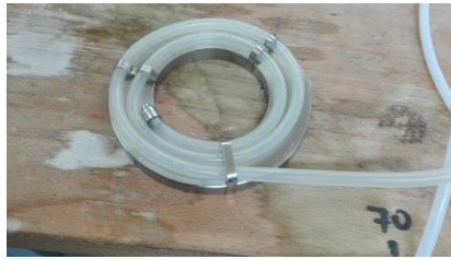
Fig. 2.1.6 - Il diffusore di gas a spirale forata
