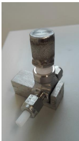
Fig. 2.1.5 - Il diffusore di gas a filtro
