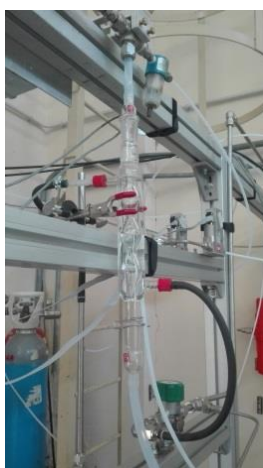
Fig. 2.1.9 - Condensatore di vetro per recupero del propanolo evaporato durante la rigenerazione
