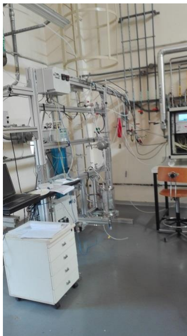
Fig. 2.1.3 - La facility sperimentale modificata per i test di upgrading con biogas sintetico
