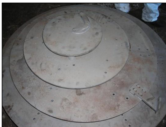
Figura 21. Griglia di scarico ceneri
