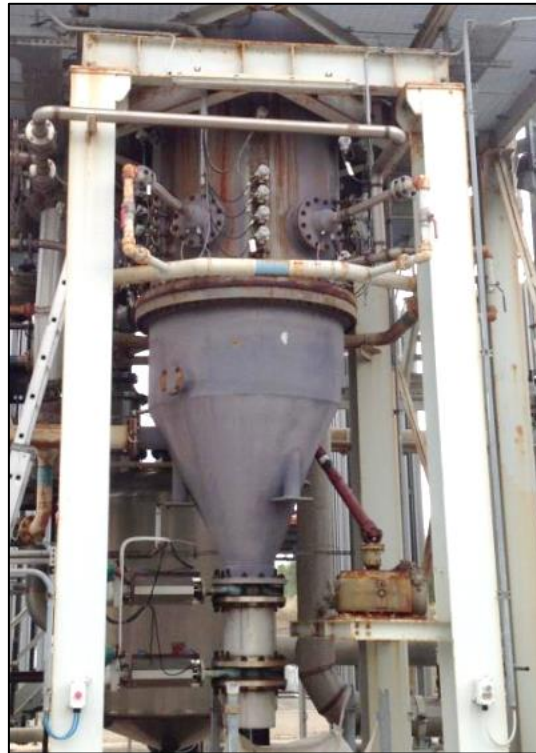
Figura 2. La parte inferiore del gassificatore Dimostrativo.
