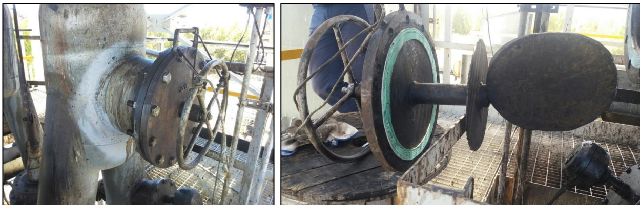
Figura 17. A - Bocchello di ispezione con sistema rompiponte, B – Sistema interno con paletta rompiponte
