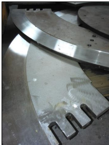
Figura 22. Particolare dei dischi di protezione del sistema di movimentazione griglia
