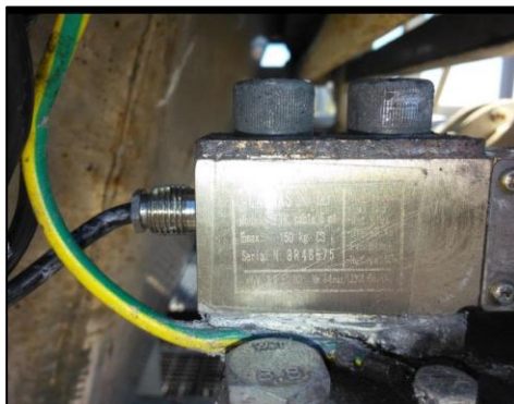
Figura 12. Immagine della cella di carico.
