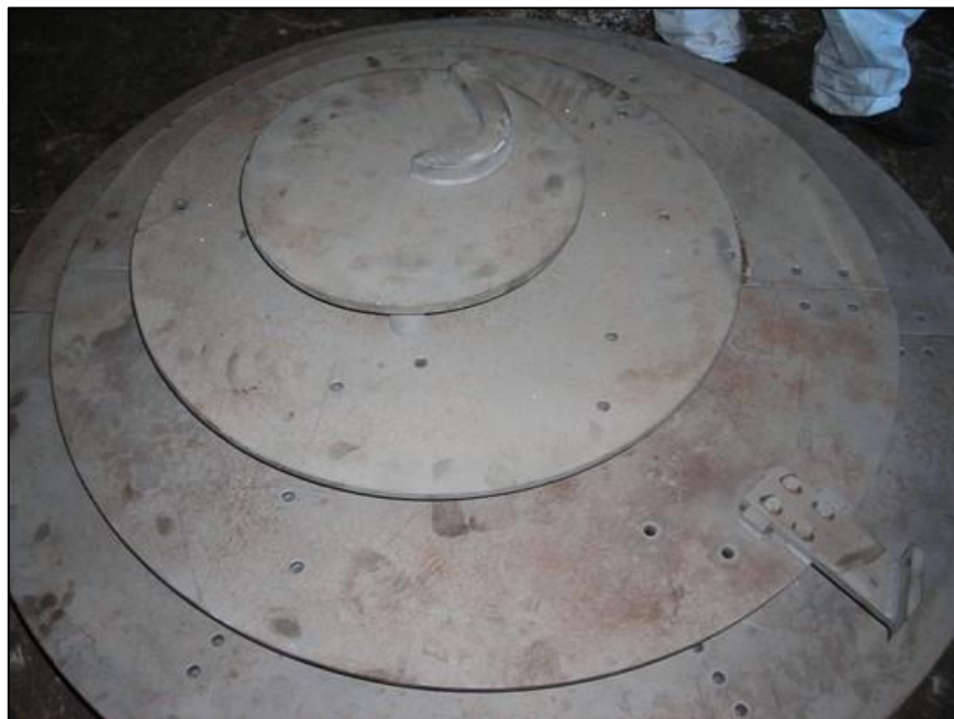
Figura 4. La parte esterna della griglia del gassificatore Dimostrativo.
