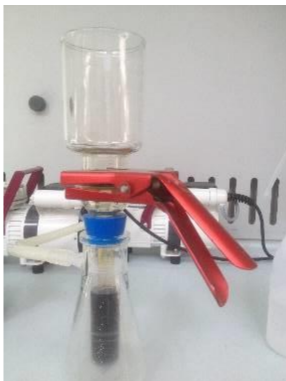
Figura 25. Sistema di filtrazione del campione separato nei condensatori: polveri e TAR vengono separati sul filtro in acetato di cellulosa, nella beuta si raccoglie il filtrato
