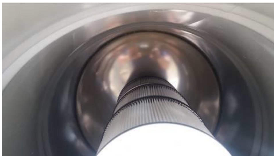
Figura 9. Filtro per MCI, sezione interna
