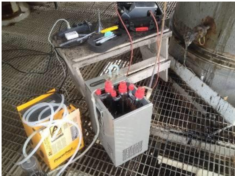
Figura 24. Sistema di campionamento per la separazione di polveri e TAR costituito da sonda di prelievo riscaldata, batteria di condensatori e misuratore volumetrico di portata
