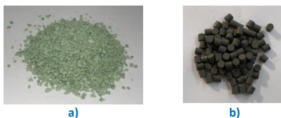
**Figura 6. Catalizzatori di metanazione utilizzati nei test con gas reale: a) catalizzatore sperimentale Ni<sub>23,7</sub>Mg<sub>56,3</sub>Al<sub>20</sub> ; b) commerciale**
