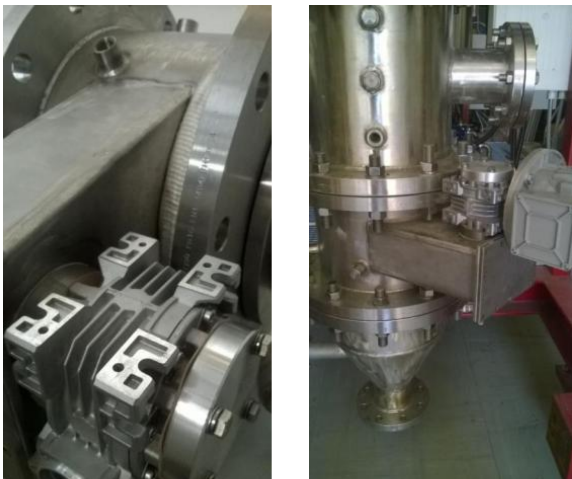
Figura 6. Nuova griglia mobile assemblata sull'impianto GESSYCA
