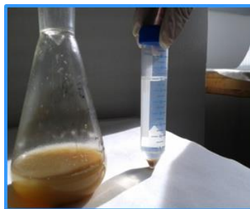
Figura 10. Ossido di grafene ottenuto mediante centrifugazione e lavaggi in acqua distillata.
