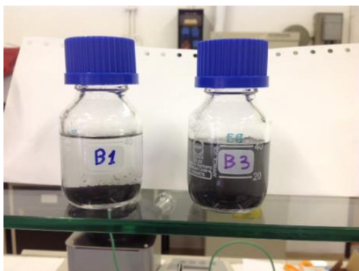
Figura 4. Campioni di grafite sonicati in acqua: B1 per 10 min e B3 per 40 min.
