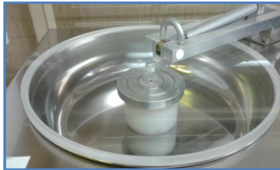
Figura 14. Spin coater utilizzato per la deposizione dei film.
