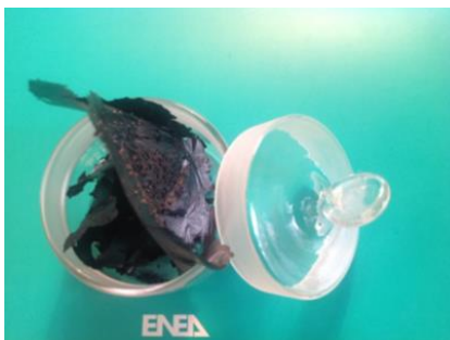
Figura 12. Ossido di grafene essiccato prodotto in laboratorio.
