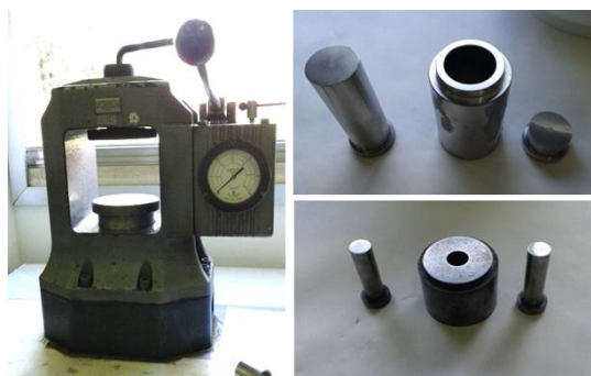
Figura 1. Pressa idraulica e stampi utilizzati per la formatura dei materiali.
