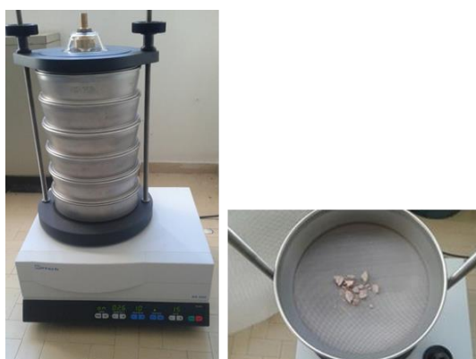
Figura 6. Vibrovagliatore e frazioni di campione dopo vagliatura
