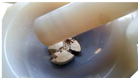
Figura 5. Frantumazione manuale e mediante pressa idrostatica
