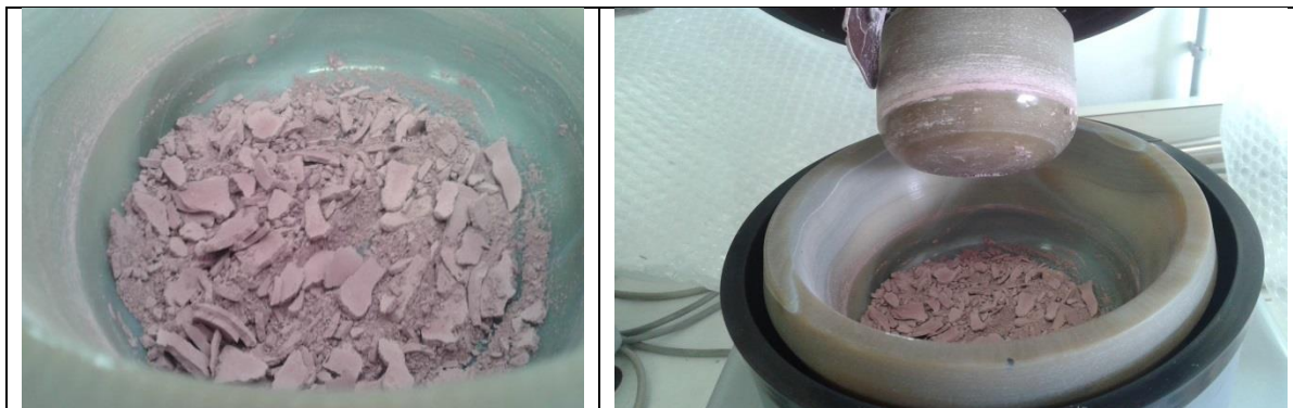
Figura 10. Miscela di Ca(OH) 2 + Fe 2 O 3 al 10%w di Fe dopo 30 minuti di macinazione effettuata nel mortaio elettrico.
