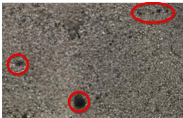
Figura 2.2-2 Dettaglio di un campione analizzato con lo strumento CHNS-O, le particelle scure cerchiare in rosso (cenosfere B) sono residui carboniosi
