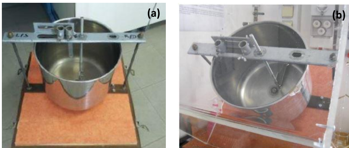
Figura 7. (a) Reattore di granulazione e (b) reattore di granulazione-carbonatazione
