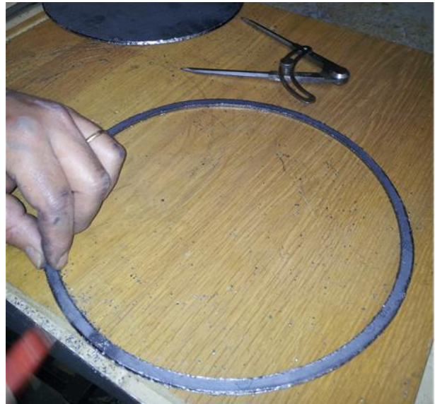
Figura 4. Realizzazione della guarnizione in grafite armata alloggiata sulla flangia del combustore.
