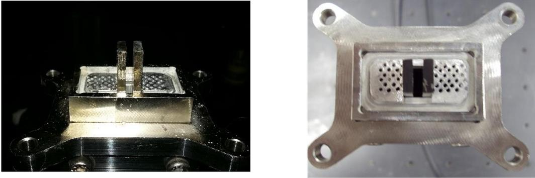
Figura 6 fotografia della piastra forata utilizzata per realizzare la fiamma pilota.
