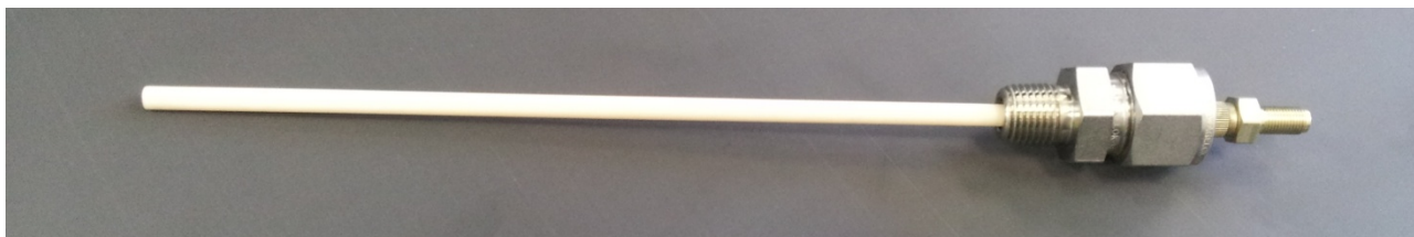
Fig. 2: Testa ottica con fibra di zaffiro monocristallino ( \Phi = 2 \text{ mm} ) in un tubo protettivo di allumina ( \Phi \approx 5 \text{ mm} ).
