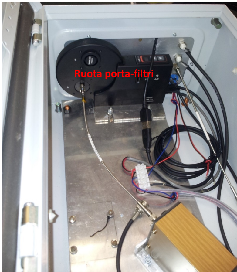
Fig. 7: Immagine della ruota porta-filtri posizionata internamente alla scatola ATEX.
