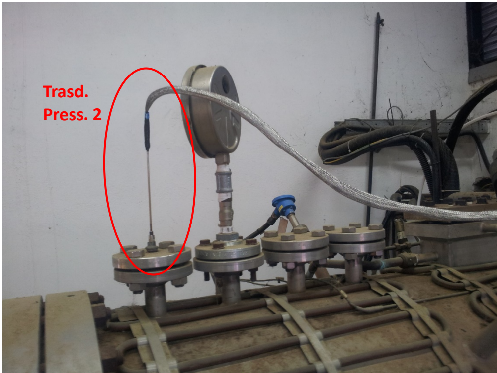
Fig. 17: Particolare del collegamento del trasduttore di pressione 2.
