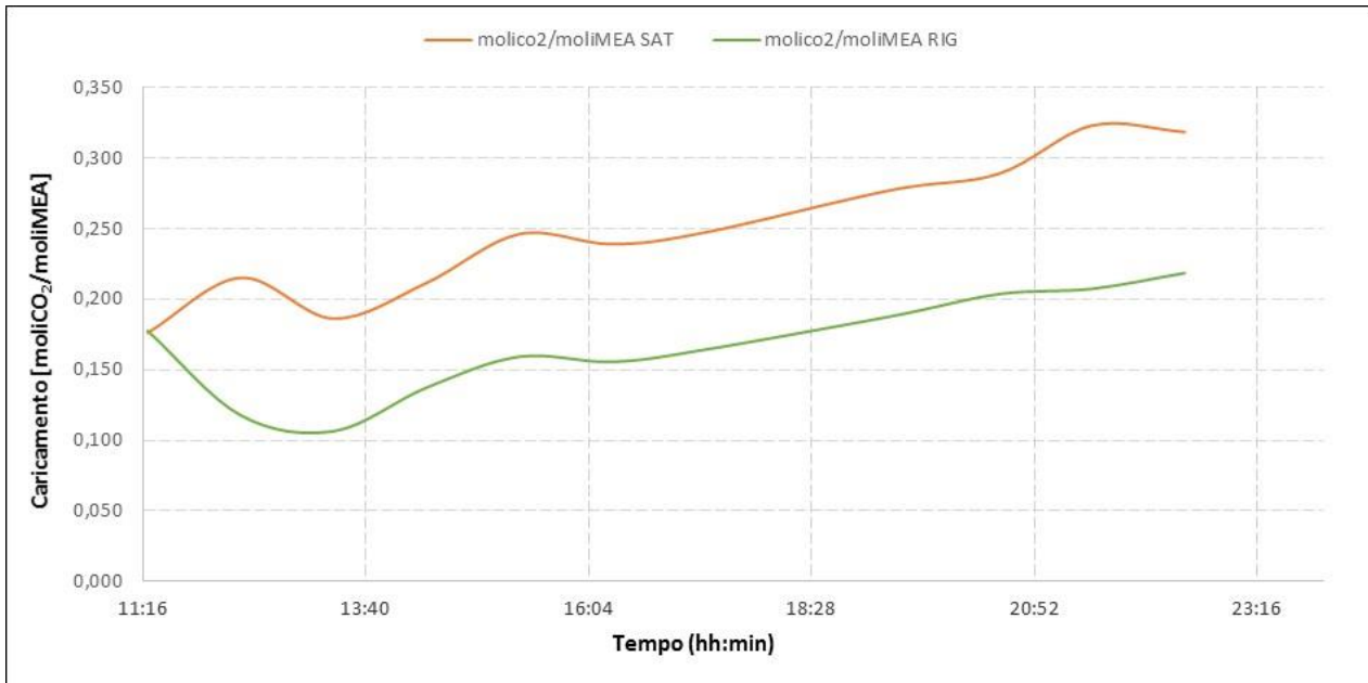
Figura 36. Andamento del caricamento durante il test per l'ammina esausta e per l'ammina rigenerata (Test del 05/05/2016)
