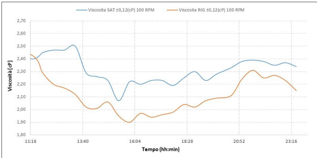
Figura 34. Andamento della viscosità (100 RPM) durante il test per l'ammina esausta e per l'ammina rigenerata (Test del 05/05/2016)
