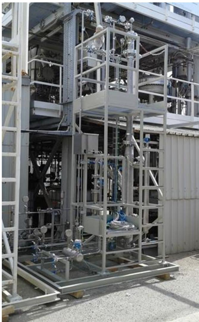
**Figura 5. Posizionamento della colonna di assorbimento della CO<sub>2</sub>**
