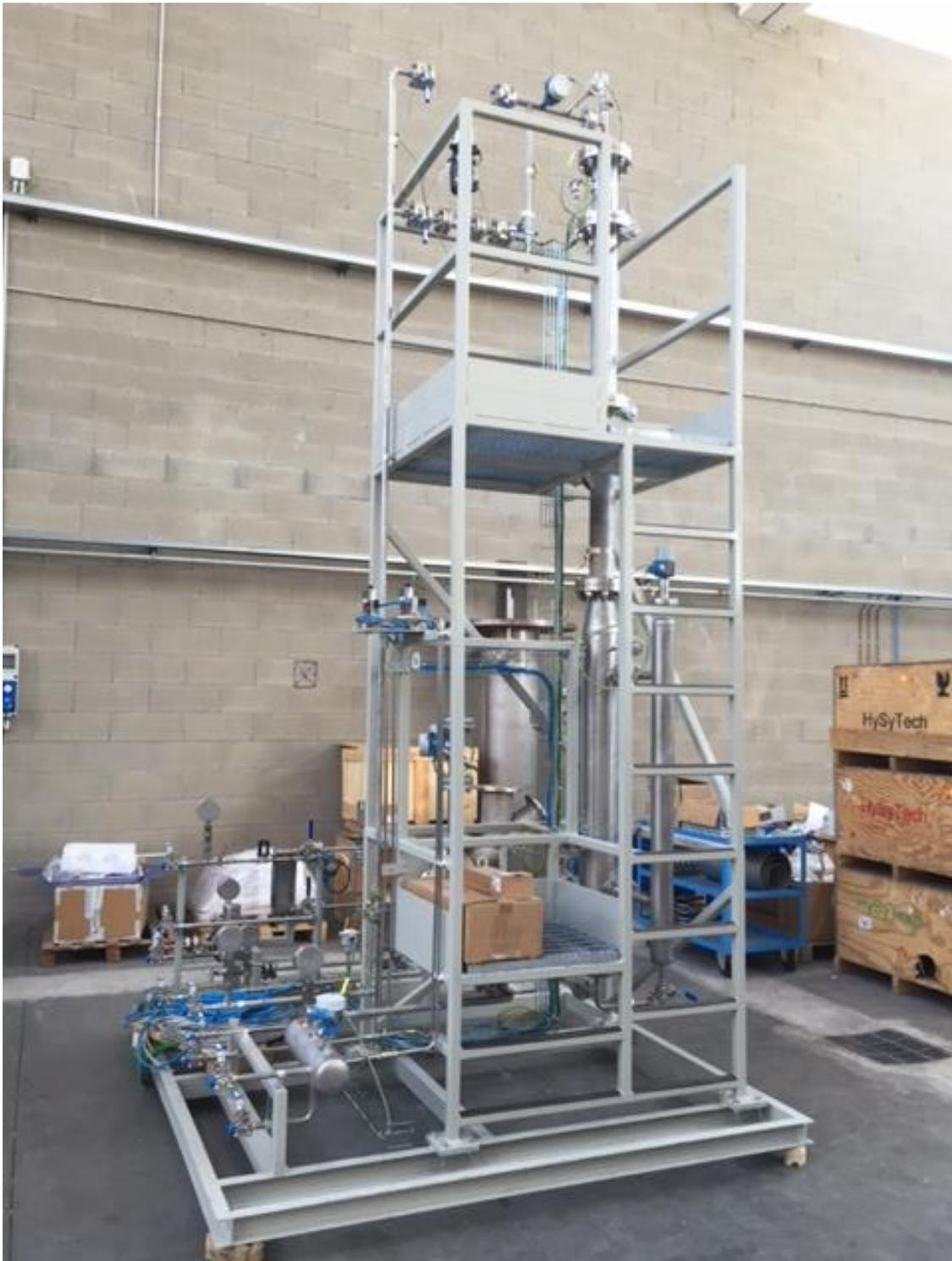
**Figura 3. Colonna di assorbimento della CO<sub>2</sub>**
