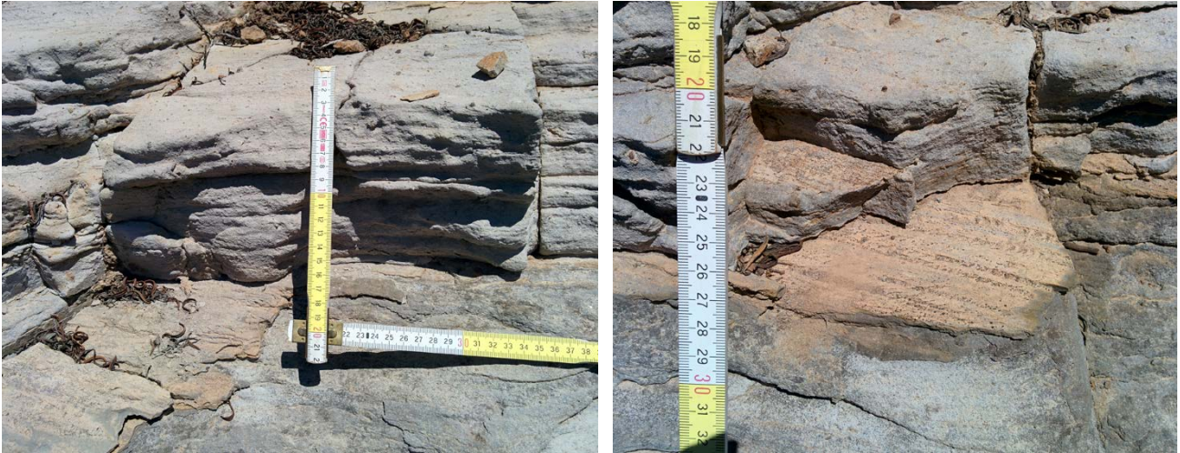
Figura 4 - Fratture nella formazione riolitica di Monte Ulmus. Notare le fratture fortemente controllate dalla stratificazione e laminazione
