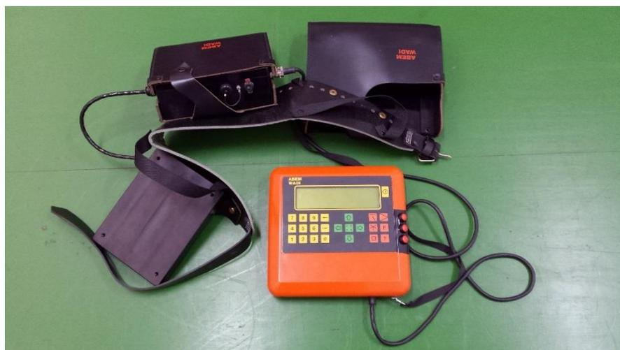
Fig.3 - Sistema elettromagnetico WADI - ABEM.
