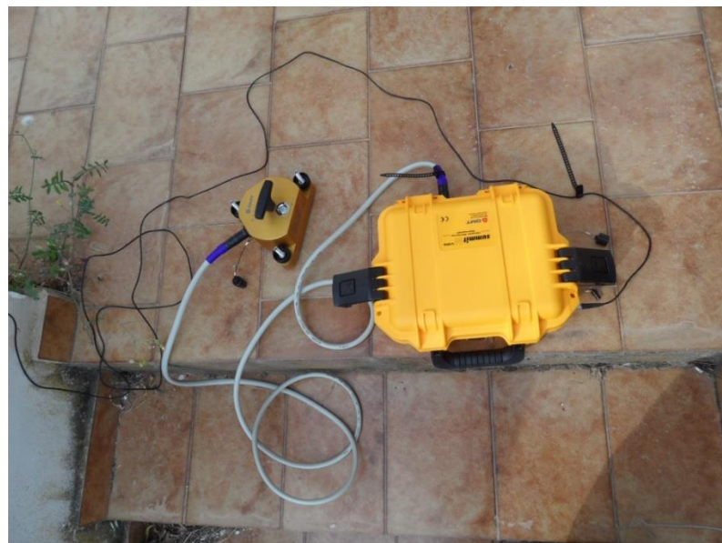
Figura 11 - Acquisitore DMT Vipa collegato a geofono 3C calibrato.
