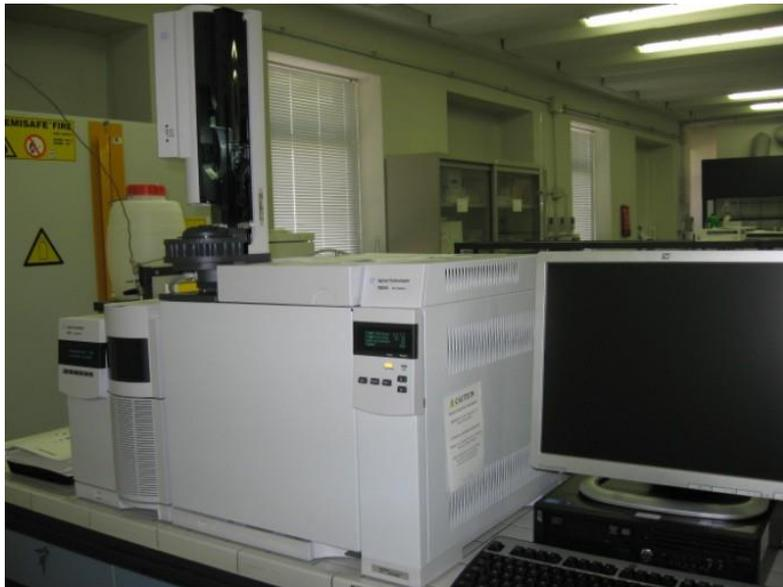
**Figura 3. Strumentazione GC-MS.**
