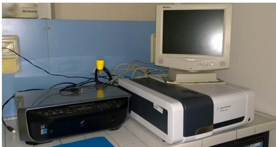
**Figura 2. Spettrofotometro UV-Vis Varian Cary 60.**
