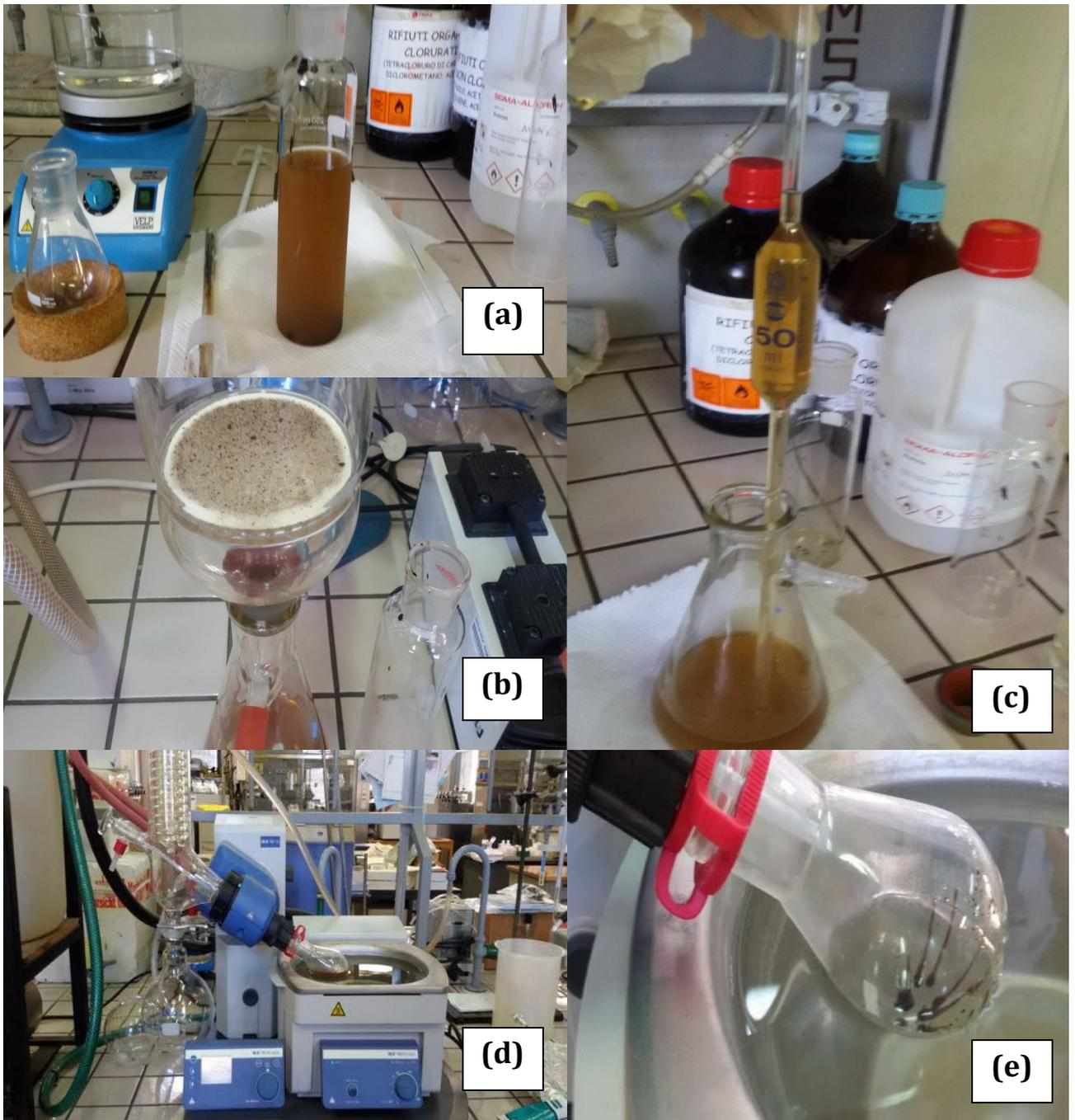
Figura 4. Procedura di preparazione del campione per l'analisi del TAR: (a), campione in isopropanolo; (b), filtrazione; (c), prelievo del filtrato; (d) evaporazione del solvente; (e) campione dopo evaporazione.
