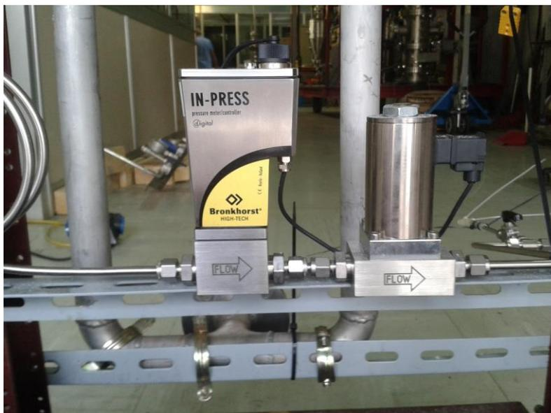
**Figura 7. Valvola di regolazione della pressione**
