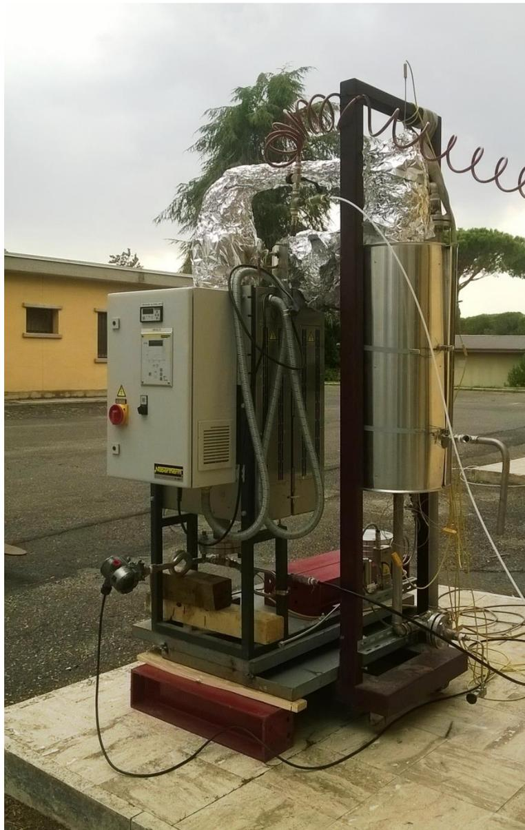
**Figura 6. Dettaglio elementi termo scaldanti e di pressurizzazione**
