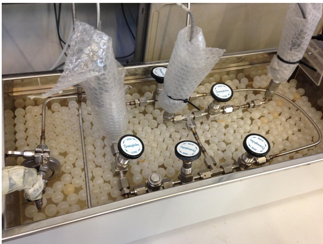
Figura 8: Foto del nuovo impianto multi funzione (pressure decay/permeometro), termostato ad acqua per la solubilità e la permeabilità di gas puri ad alta pressione. Le palline di plastica servono, a impianto riempito di acqua, per limitare l'evaporazione
