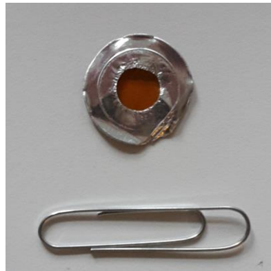
Figura 7: nuove membrane prodotte e caratterizzate: a) membrana poliimidica DAP-TI e relativa membrana riarrangiata termicamente a 450°C, DAP TR450; b) membrana DAR PI e relativa membrana riarrangiata termicamente DAR TR450; c) esempio di preparazione di una membrana per la prova nell'impianto di permeazione.
