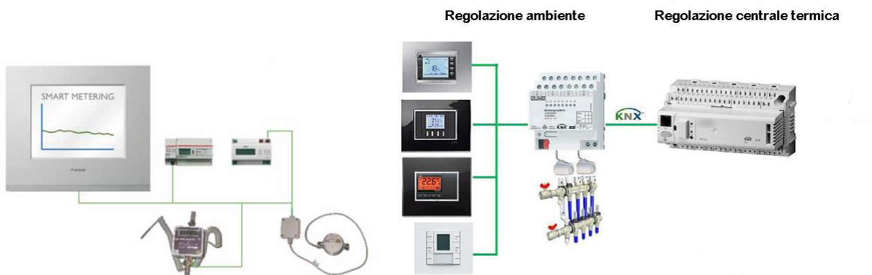
Figura 117. Applicazioni KNX. Sistema di lettura e sistema di regolazione.
