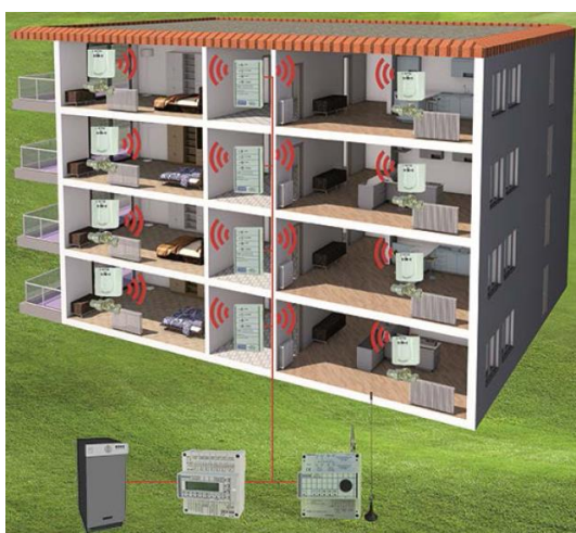
Figura 90. Architettura del sistema di regolazione wireless. Costruttore 3.
