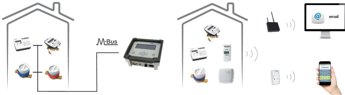
Figura 107. Sistema di contabilizzazione su bus. Sistema M-Bus cablato (a sin) e sistema WM-Bus (a dx)
