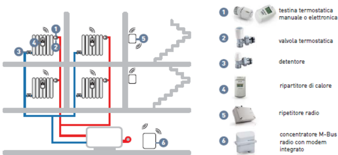
Figura 95. Architettura del sistema di acquisizione dati AMR.
