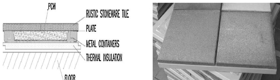
Figura 14. Schema del sistema proposto da Ceron et al. [49].
