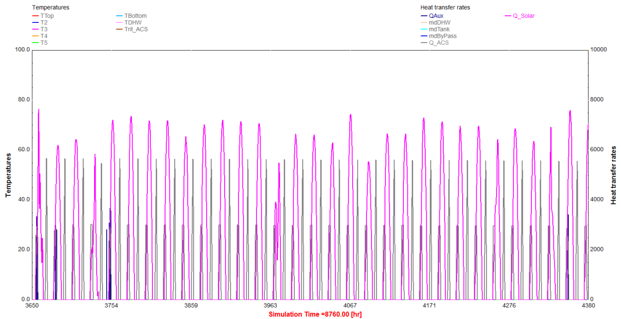
Figura 110. Andamento della produzione di calore solare (lilla), della potenza termica per ACS (grigio) e potenza termica dell’ausiliario – resistenza elettrica (blu) per il mese di Gennaio.
