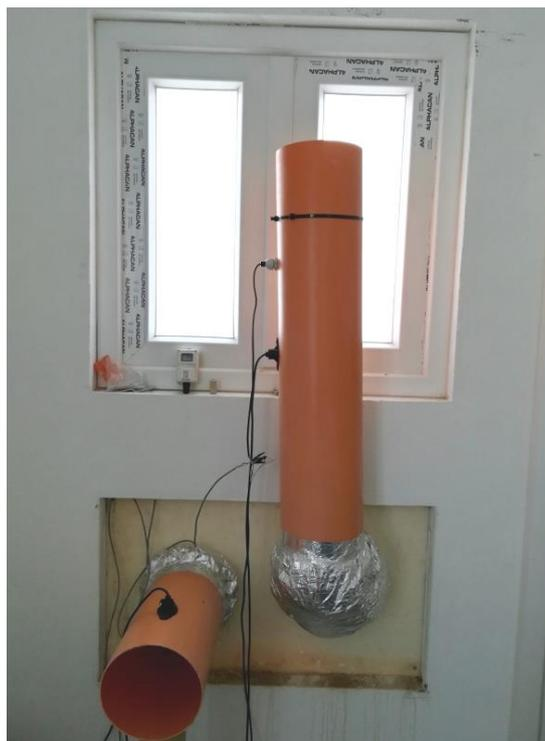
Figura 159: canalizzazione d'aria interna alla cabina sperimentale
