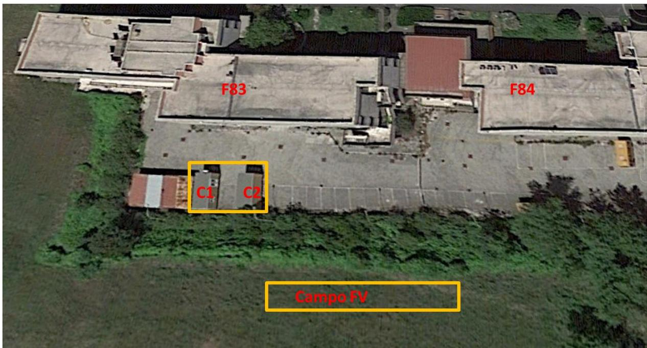
Figura 72: Dettaglio sito di installazione dell'impianto ibrido, cabina 1 (C1) e cabina 2 (C2) e area oggetto di posa del campo fotovoltaico
