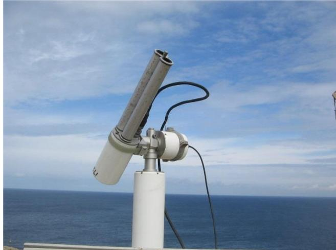
Figura 170: Fotometro solare Cimel CE 318 operante a Lampedusa.
