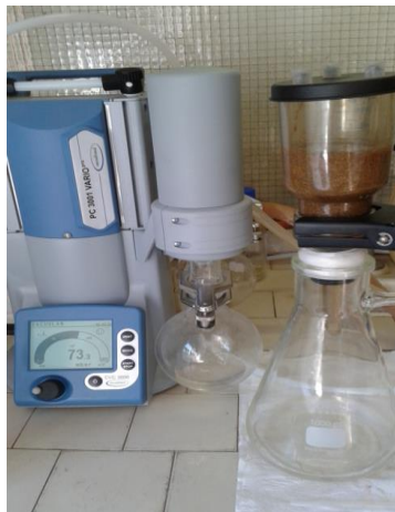
Figura 44. Filtrazione sotto vuoto della sospensione acida di ossido di grafite e ossido di grafene.
