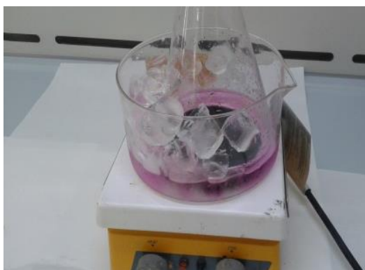
Figura 41. Campione di grafite in acido solforico durante l'aggiunta di permanganato di potassio.
