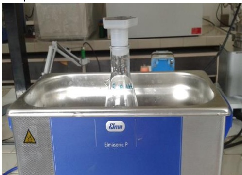
Figura 47. Sonicazione della miscela Grafite+ acido solforico in un bagno ad ultrasuoni
