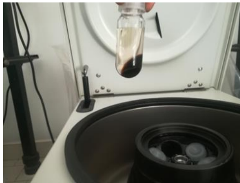
Figura 51. Processo di centrifugazione effettuato a 10000giri/min per 10 minuti.
