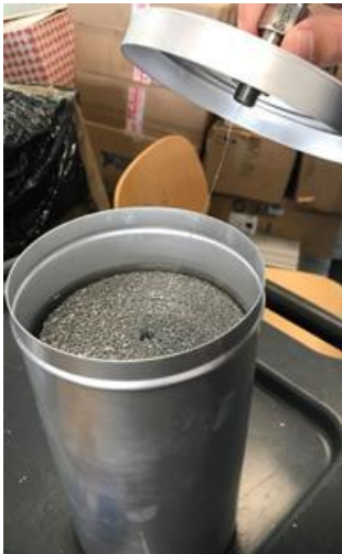
Figura 29. Posizionamento delle termocoppie per effettuare le misure di temperatura nel caso di sistema di accumulo con PCM e schiuma metallica.
