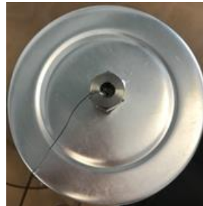
Figura 29. Posizionamento delle termocoppie per effettuare le misure di temperatura nel caso di sistema di accumulo con PCM e schiuma metallica.
