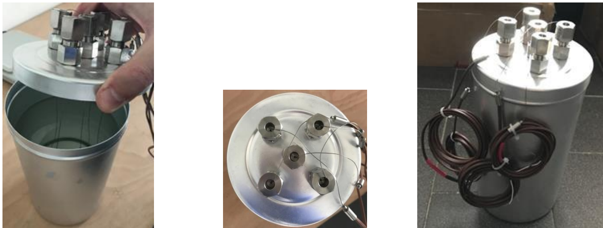
Figura 28. Posizionamento delle termocoppie per effettuare le misure di temperatura nel caso di sistema di accumulo con solo PCM.
