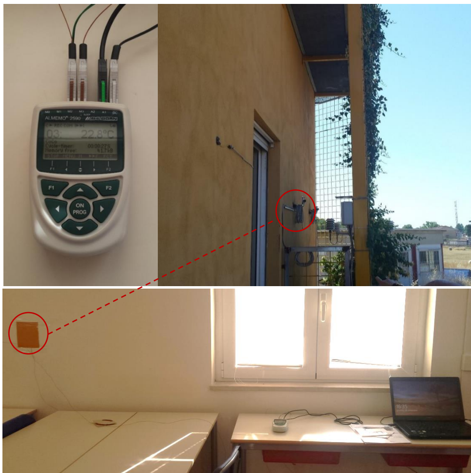
Figura 51: sistema di monitoraggio termocoppie + datalogger
