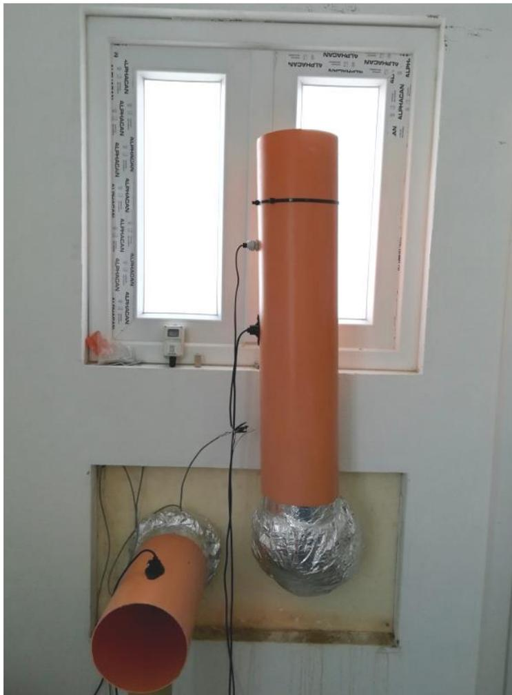
**Figura 135** Canalizzazioni dell'aria di mandata e ripresa con relativi sensori di temperatura, umidità relativa e velocità dell'aria
