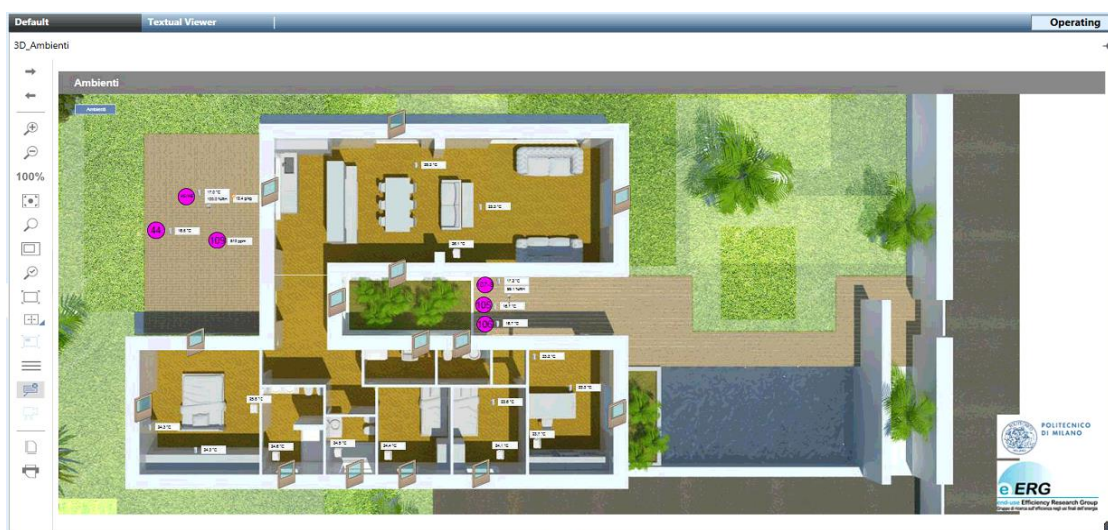
Figura 4. Interfaccia Desigo - Rappresentazione degli ambienti dell'edificio con valori misurati dai principali sensori e stato di apertura delle finestre, nella piattaforma di supervisione del sistema di controllo e monitoraggio.
