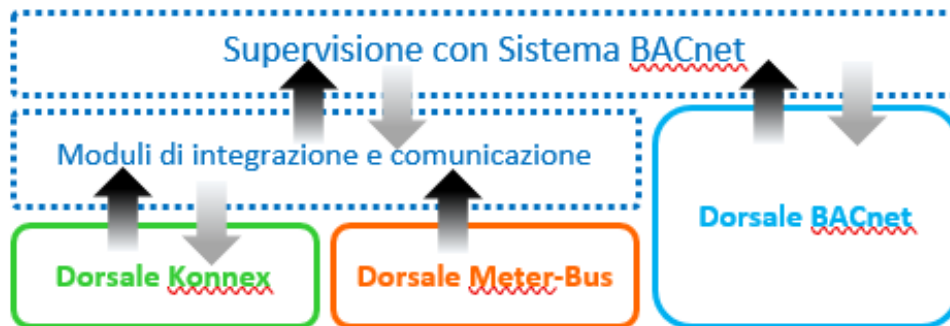
Figura 2. Struttura schematica del sistema di controllo e monitoraggio.
