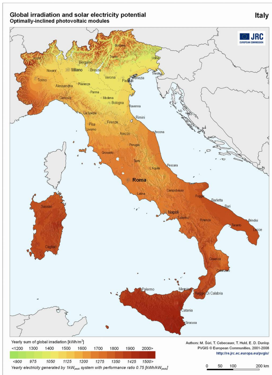
Figura 15: Irraggiamento globale (kWh/mq) e potenziale di produzione annuale (kWh/kWp), con pannelli montati con inclinazione ideale (fonte: PVGIS © European Union, 2001-2008).
