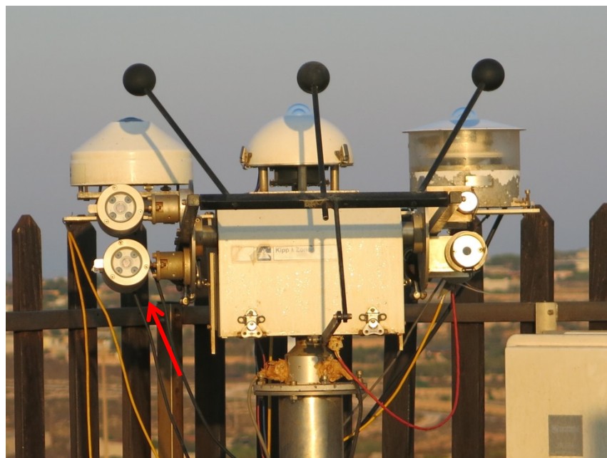
Figura 92. Inseguitore solare Kipp and Zonen 2AP equipaggiato con un pirgeometro, due piranometri, un pireliometro e due fotometri Middleton evidenziati dalla freccia rossa.
