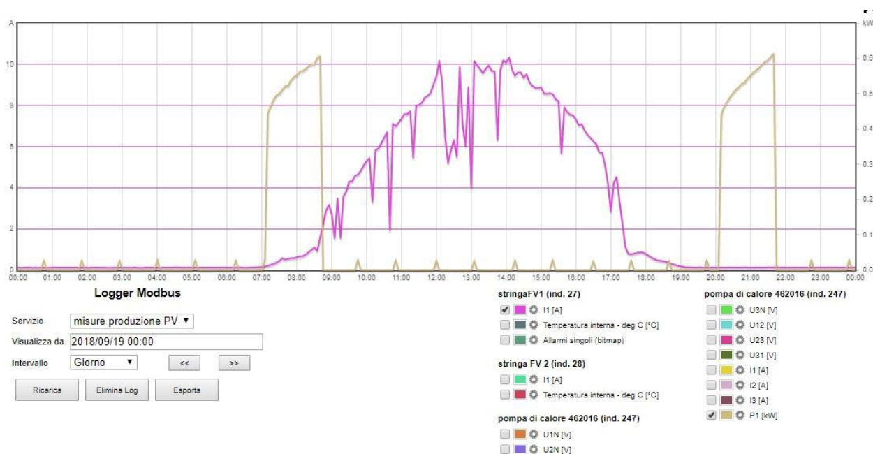
Figura 64: piattaforma web per il monitoraggio e la memorizzazione delle misure dell'impianto sperimentale (giallo: potenza assorbita dalla pompa di calore (kW), fucsia corrente erogata dalla stringa 1 (A))
