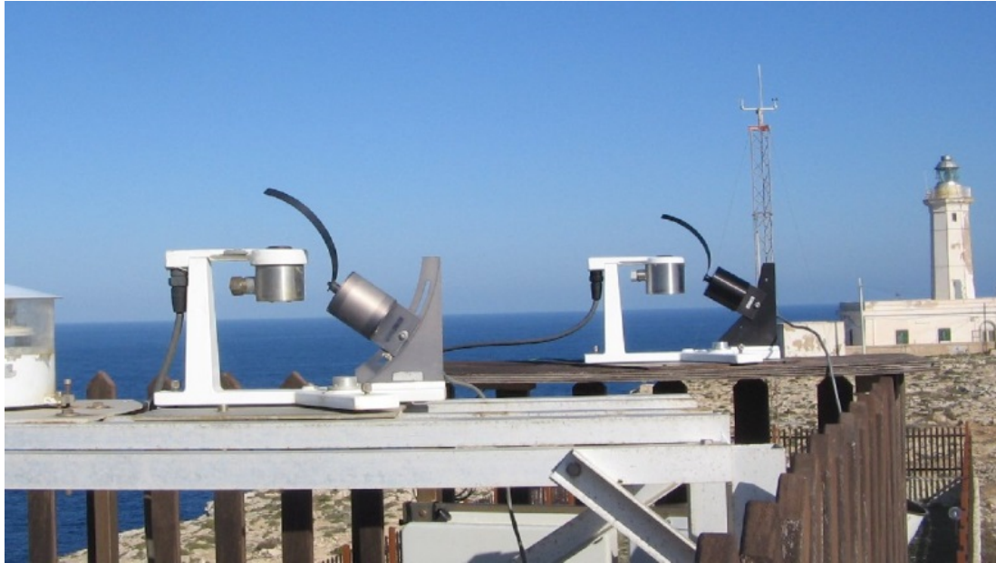
Figura 93. Radiometri a banda rotante MFRSR in funzione; la banda rotante proiettando la sua ombra sullo strumento consente la misura della radiazione globale e di quella diffusa.
