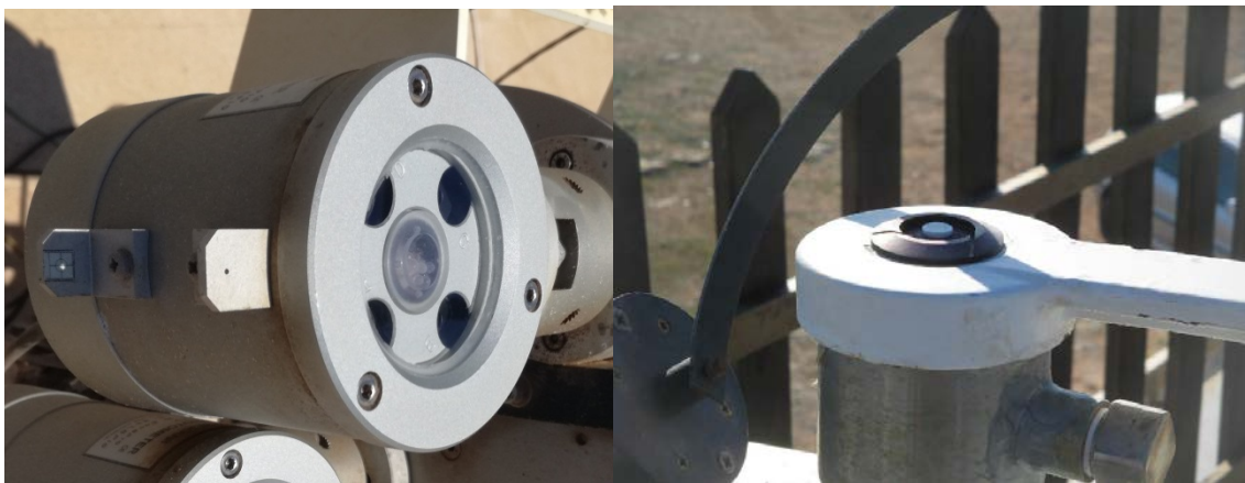
Figura 94. Dettaglio dell'ottica di ingresso del fotometro Middleton SP02 (sinistra) e del radiometro MFRSR (destra) che utilizzano rispettivamente una finestra ed un diffusore
