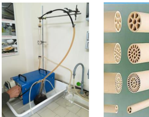
Figura 6. Set-up dell’impianto di microfiltrazione tangenziale e tipi di membrane ceramiche.
