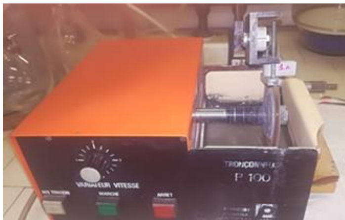
Figura 11. Set-up per il taglio delle barrette e campioni prima e dopo il taglio.
