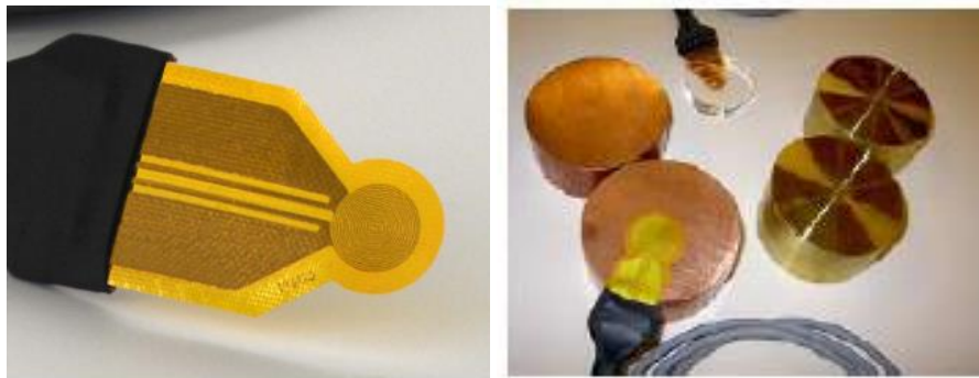
Figura 39 Sensori per misure termiche.
