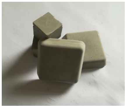
Figura 40. Foto di alcuni provini di cemento e cemento +%GO con geometrie diverse utilizzati per le prove Conducibilità termica.
