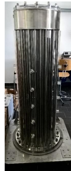
Figura 8. Foto del serbatoio con mantello in plexiglass.
