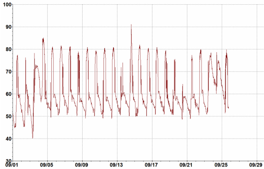
Figura 93 - Temperature alimentazione macchina ad assorbimento, settembre 2018
