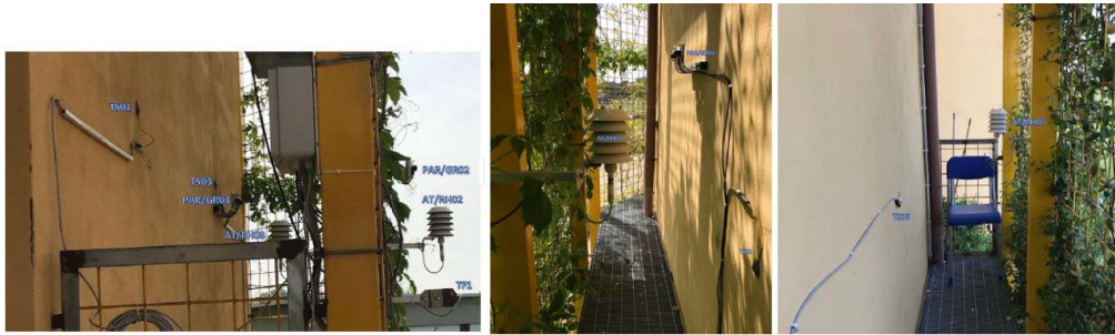
Figura 3. Disposizione sensori nel "gap"
