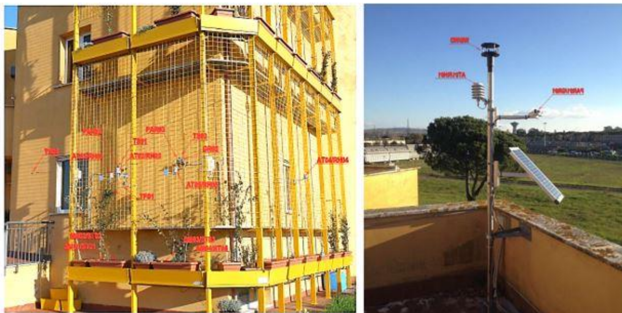
Figura 1. Disposizione sensori-primo periodo
