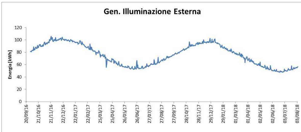
Figura 10 - Andamento consumi impianto illuminazione luci esterne edificio 14d
