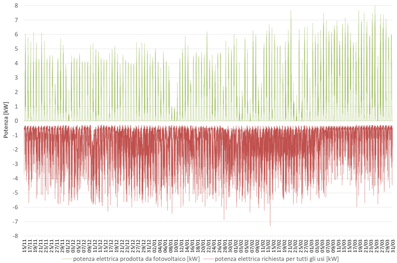
Figura 23. Potenza elettrica prodotta da fotovoltaico e richiesta per tutti gli usi dell'edificio, nel periodo di riscaldamento (15 novembre 2017 - 31 marzo 2018).
