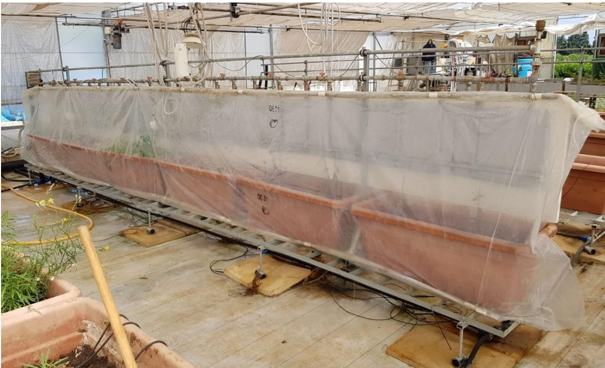
Figura 27: Sistema di tubi e piastre di raffreddamento con chiusura in film plastico della zona di coltivazione.
