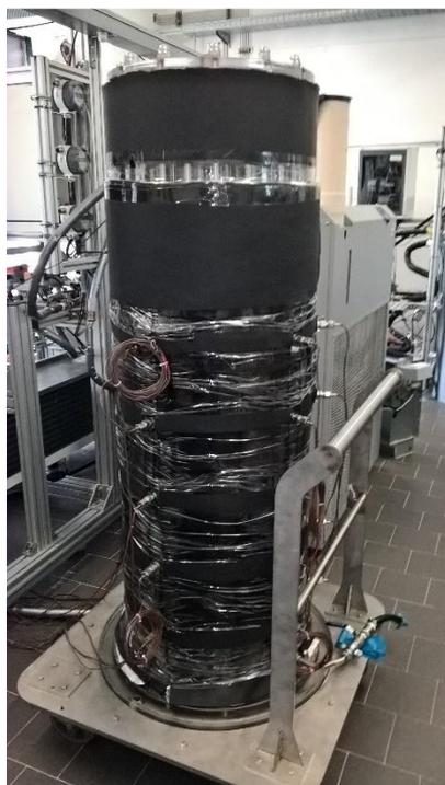
Figura 12. Serbatoio con mantello in plexiglass isolato termicamente.
