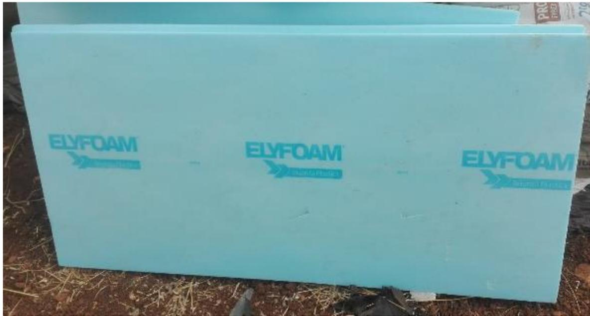
Figura 2: Pannelli termoisolanti in polistirene espanso estruso con spessore pari a 50 mm usati per la realizzazione del prototipo presso il campo sperimentale dell'Università di Bari.
