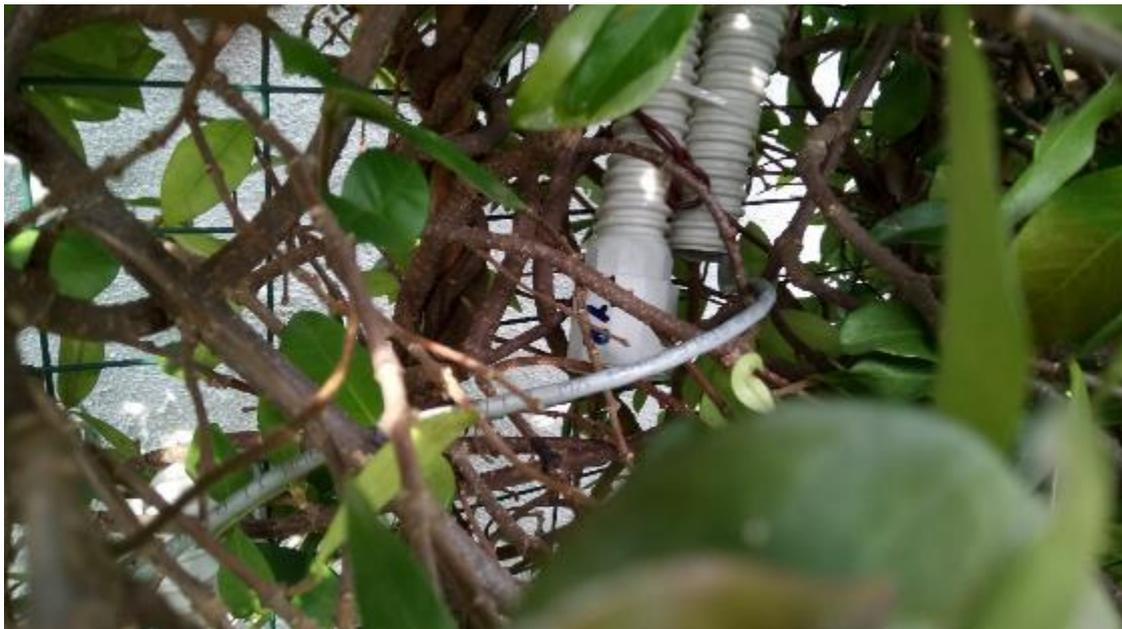
Figura 15: Sensori per misurare la temperatura e l'umidità relativa dell'aria all'interno dello strato fogliare.
