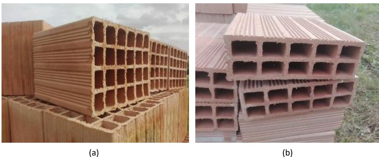
Figura 1: Mattoni forati usati per la realizzazione del prototipo presso il campo sperimentale dell'Università di Bari: a) mattoni forati a 24 fori usati per la realizzazione della parete rivolta a sud; b) mattoni forati a 10 fori usati per la realizzazione dei rinforzi.
