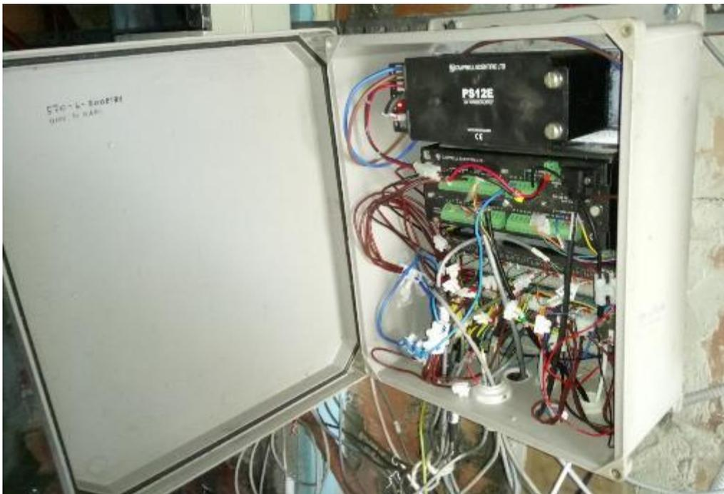
Figura 10: Data logger posizionato all'interno del prototipo presso il campo sperimentale dell'Università di Bari.
