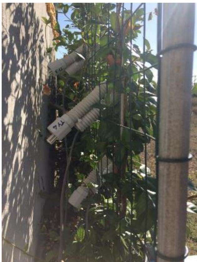
Figura 14: Sensori per misurare temperatura e umidità relativa dell'aria all'interno della intercapedine tra parete e vegetazione.
