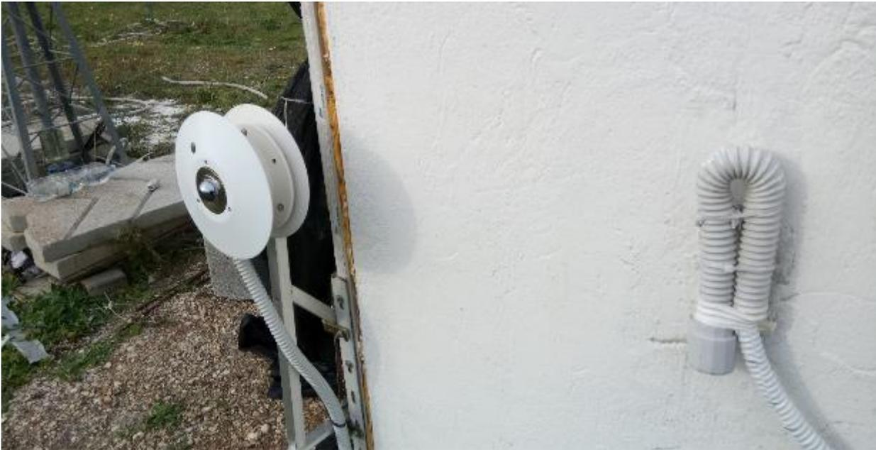
Figura 11: Piranometro presso il campo sperimentale dell'Università di Bari.
